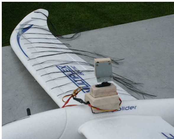
Abbildung 33 Tragfläche mit aufgeklebten Carbonfasern
