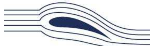
Abbildung 9 Auftriebssteigerung durch Anstellung eines halbsymmetrischen Profils
