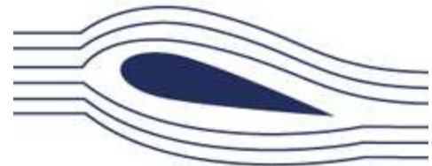
Abbildung 8 Durch Anstellung eines vollsymmetrischen Profils entsteht Auftrieb.
