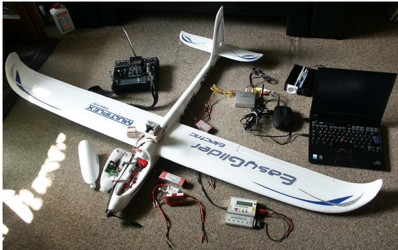
Abbildung 32 Überblick über das gesamte Video-Funk-Equipment. Die Aufzeichnung des Funksignals erfolgt direkt digital per Notebook
